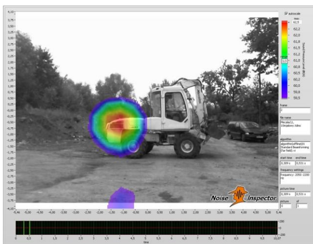
Rys. 7. Maszyna podczas pracy jałowej – strona prawa n = 1700 obr/min, odległość zdjęcia 10m, zakres częstotliwości: 340-2800 Hz
