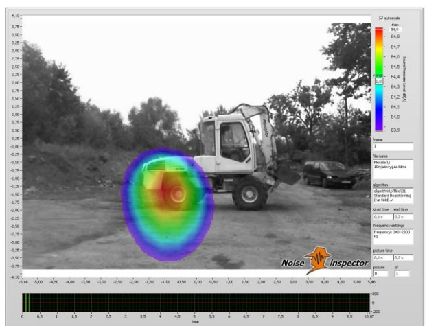
Rys. 8. Maszyna podczas pracy jałowej – strona prawa n = 2150 obr/min, odległość zdjęcia 10m, zakres częstotliwości: 340-2800 Hz
