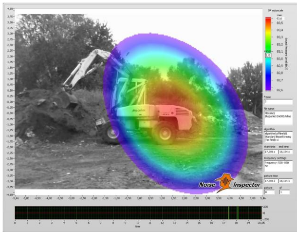
Rys. 13. Maszyna podczas kopania – strona lewa odległość zdjęcia 10m, zakres częstotliwości: 500-850 Hz
