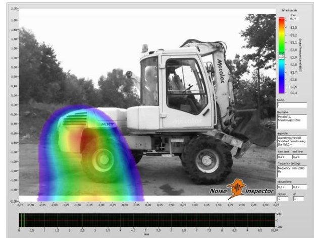
Rys. 6. Maszyna podczas pracy jałowej – strona prawa n = 2150 obr/min, odległość zdjęcia 5m, zakres częstotliwości: 340-2800 Hz
