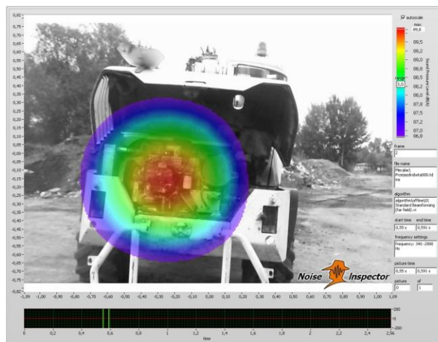
Rys. 18. Maszyna podczas pracy jałowej – tył maszyny odległość zdjęcia 5m, zakres częstotliwości: 340-2800 Hz
