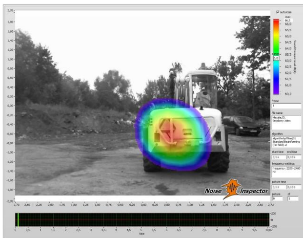
Rys. 15. Maszyna podczas pracy jałowej – tył maszyny odległość zdjęcia 5m, zakres częstotliwości: 2200-2400 Hz
