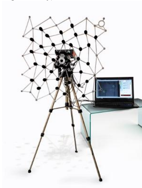
Rys. 4. Zestaw do pomiaru poziomu dźwięku z kamerą akustyczną.
