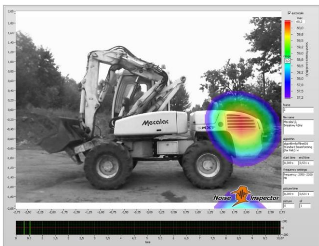
Rys. 9. Maszyna podczas pracy jałowej – strona lewa n = 1700 obr/min, odległość zdjęcia 5m, zakres częstotliwości: 2050-2200 Hz
