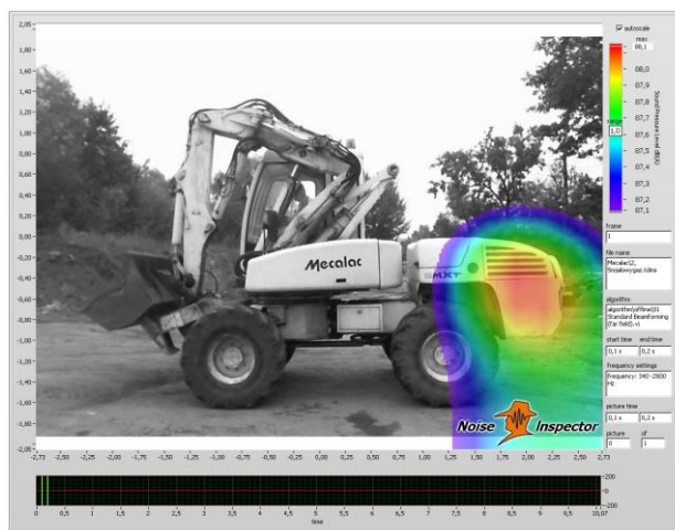
Rys. 10. Maszyna podczas pracy jałowej – strona lewa n = 2150 obr/min, odległość zdjęcia 5m, zakres częstotliwości: 340-2800 Hz
