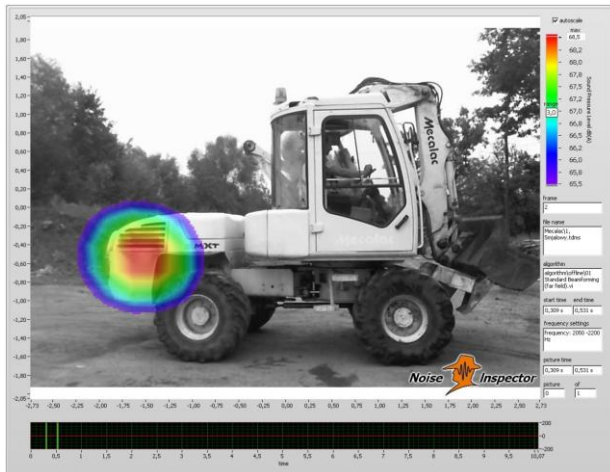
Rys. 5. Maszyna podczas pracy jałowej – strona prawa n = 1700 obr/min, odległość zdjęcia 5m, zakres częstotliwości: 2050-2200 Hz
