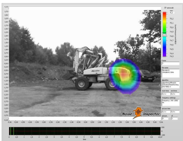
Rys. 11. Maszyna podczas pracy jałowej – strona lewa n = 1700 obr/min, odległość zdjęcia 10m, zakres częstotliwości: 340-2800 Hz
