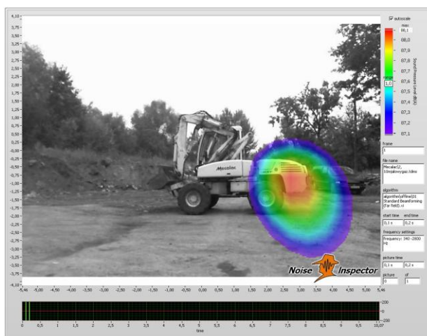
Rys. 12. Maszyna podczas pracy jałowej – strona lewa n = 2150 obr/min, odległość zdjęcia 10m, zakres częstotliwości: 340-2800 Hz
