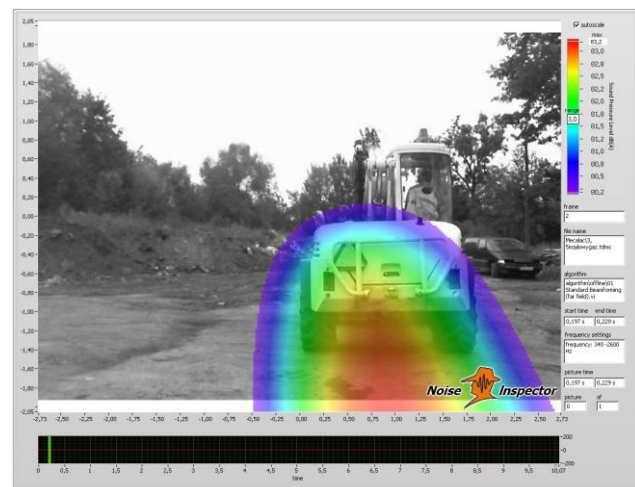
Rys. 16. Maszyna podczas pracy jałowej – tył maszyny odległość zdjęcia 5m, zakres częstotliwości: 340-2600 Hz
